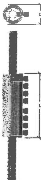
Fig. 2 Reprezentarea schematică a îmbinării mecanice a armăturilor cu cuplă Unitec Standard
