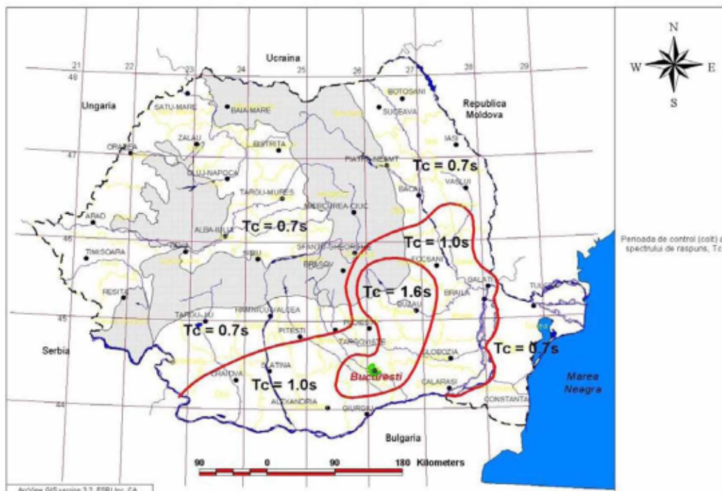
Figura 3.2 Zonarea teritoriului României în termeni de perioada de control (colt), T_c a spectrului de răspuns, T_c
