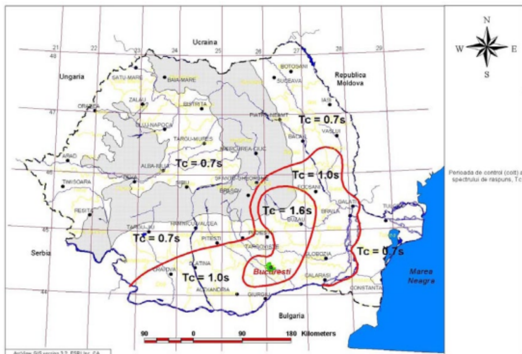
Figura 3.2 Zonarea teritoriului României in termeni de perioada de control (colt), T_c a spectrului de raspuns
