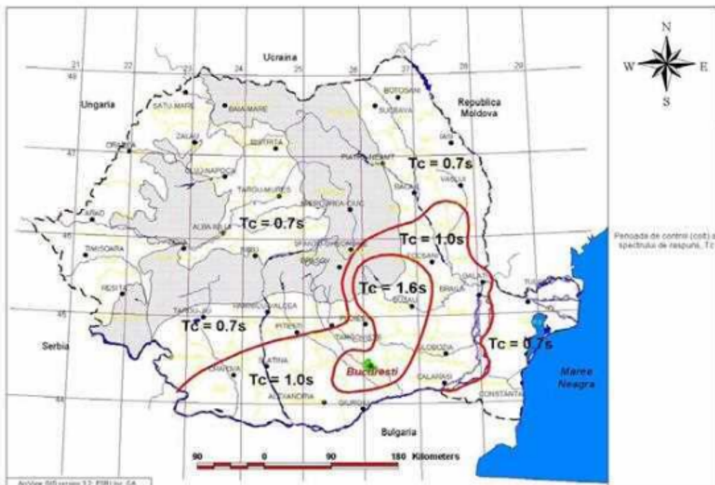
Figura 3.2 Zonarea teritoriului României în termeni de perioada de control (colt), T_c a spectrului de raspuns
