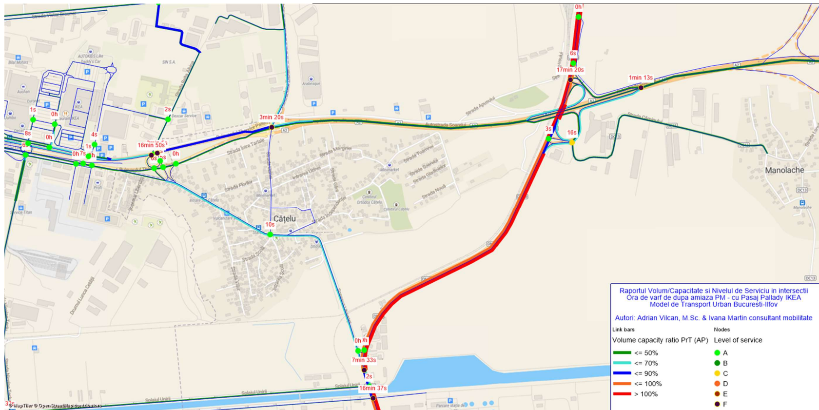
Fig. 54 – Întârzieri si Nivelul de Serviciu in intersecții - Raportul Volum/Capacitate pe bara dintre intersecții - scenariul cu pasaj IKEA, ora de vârf de după amiaza PM, detaliu Est
